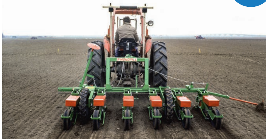
Zesrijge zaaimachine van het type binnenvuller. De opmars van de binnenvullers begon vanaf ongeveer 1985.
