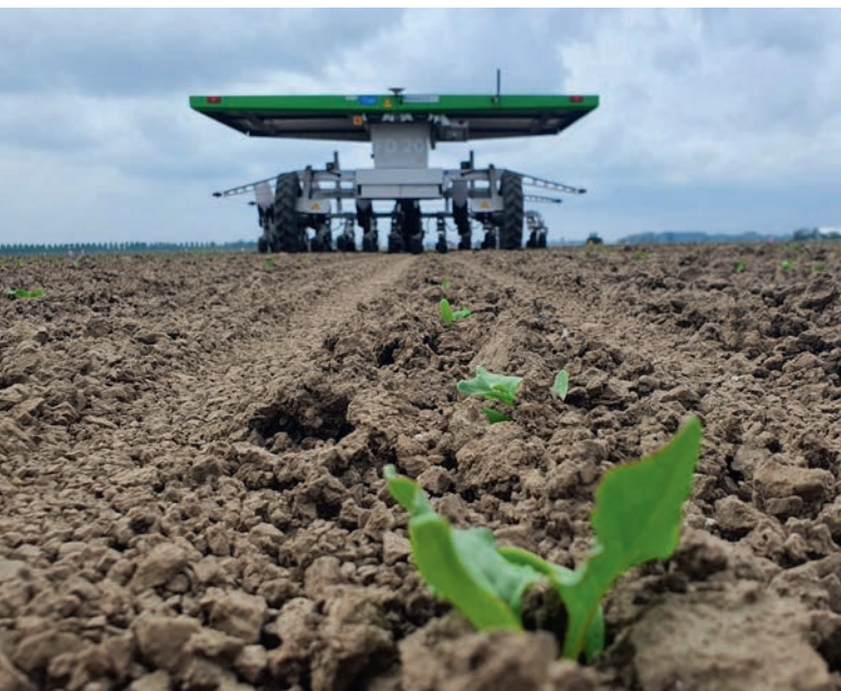
Afbeelding 1: De FarmDroid is een voorbeeld van een techniek die ingezet kan worden voor mechanische onkruidbeheersing (foto: IRS).
