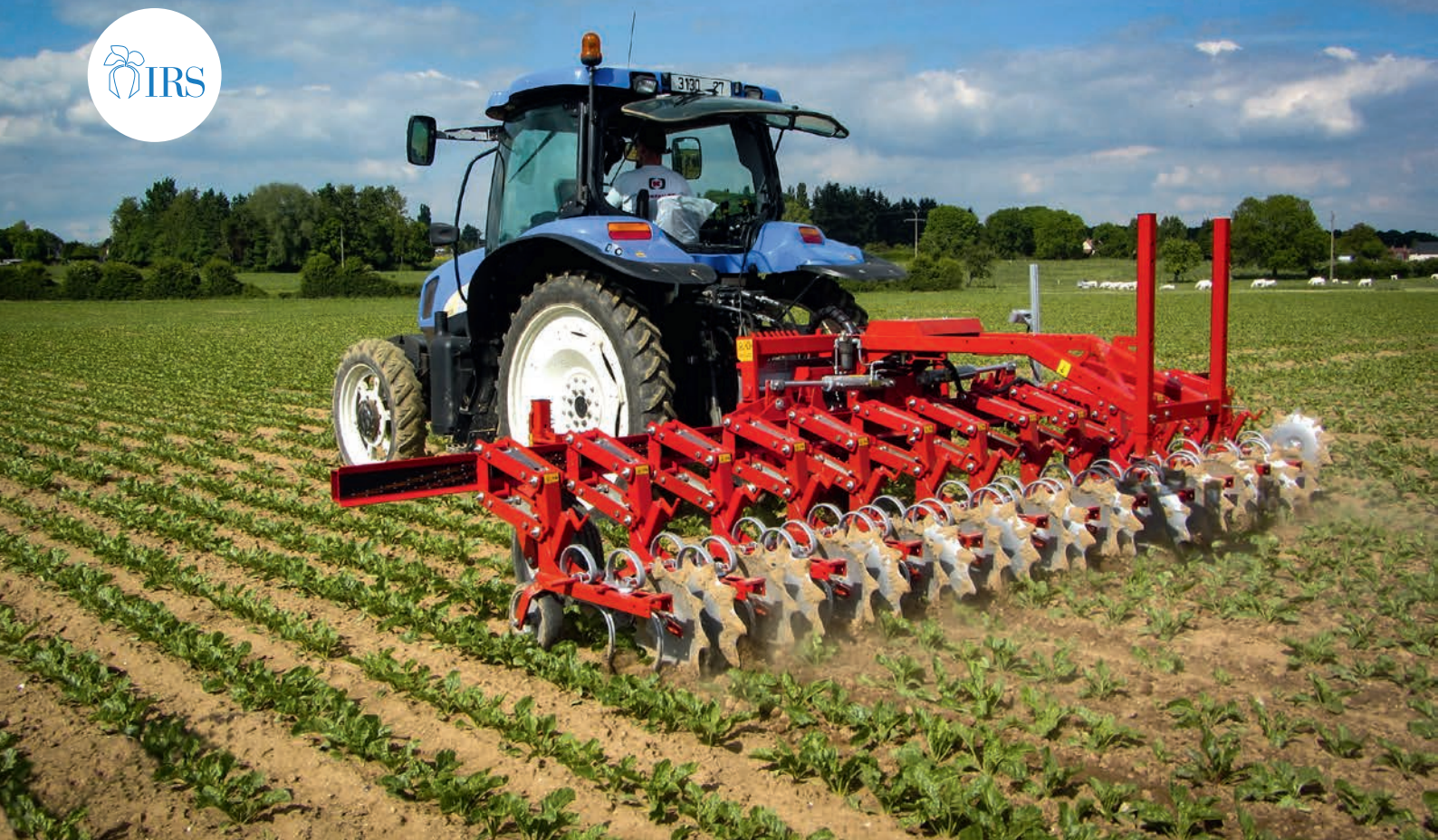
Cameragestuurde schoffelmachine, waardoor dichter langs de gewasrij geschoffeld kan worden
