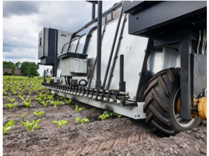
De Robotti, een autonome werktuigendrager van AgroIntelli, werd toegelicht door Johan Booij (WUR) en Kevin Grooters (AgroIntelli). Onder de kap zitten vier camera's voor de herkenning van bieten, aardappelen en onkruid. Er achter zit een spuitboom met om de 10 cm een dop. WUR en AgroIntelli werken aan een verbetering van het herkenningsalgoritme. De bieten werden, door de gekrulde bladeren door insectenaantastingen, minder goed herkend dan de bieten van vorig jaar.
