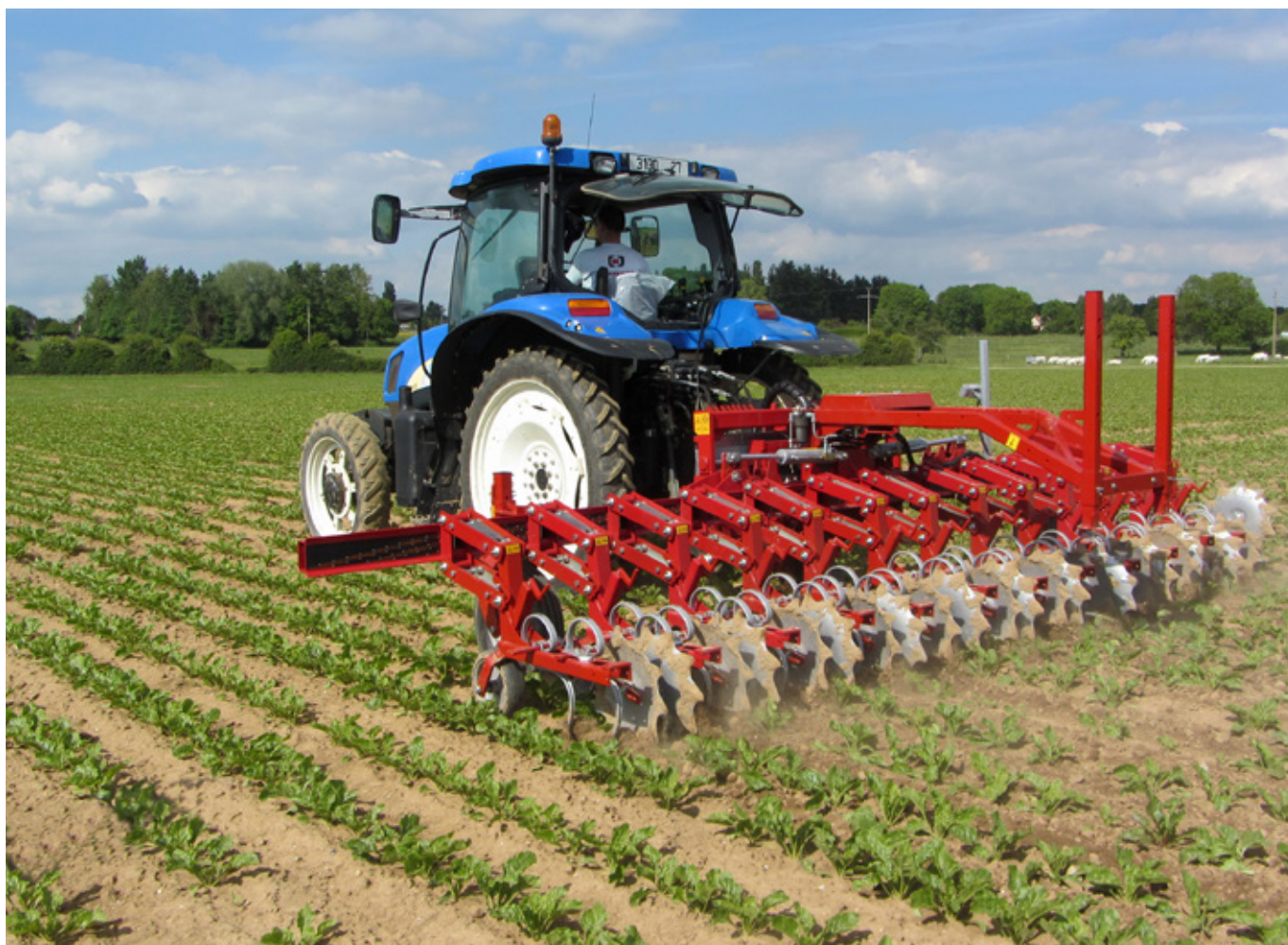
Met cameragestuurde schoffelmachines kan zeer nauwkeurig langs de rij worden geschoffeld.
