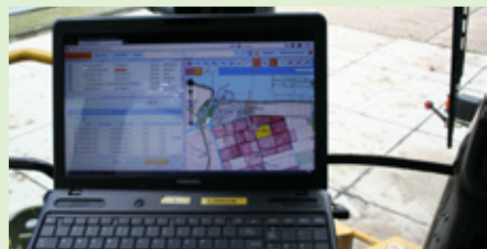
Boordcomputer in cabine verspreidingsmachine
