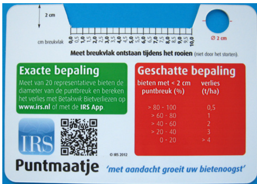
Figuur 2. Puntmaatje voor bepaling puntbreuk. De tabel helpt om rooiverliezen als gevolg van puntbreuk snel te schatten. De app, toegankelijk via de QR-code, is voor het exacter bepalen van puntbreuk. Bij een puntbreuk kleiner dan 2 cm diameter is het verlies verwaarloosbaar. Een gat van 2 cm diameter helpt hierbij. Het Puntmaatje kan hiermee ook opgehangen worden in de cabine van de rooier.
