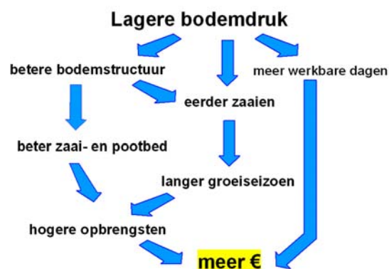
Figuur 2 De voordelen van rijden op lage bodemdruk
