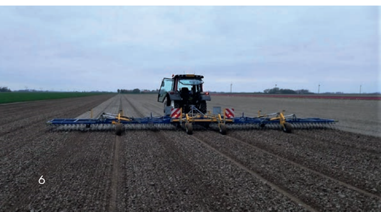
Afbeelding 1: Eggen met een brede wiedege kan worden toegepast in grond die nog redelijk zacht is om korstvorming te voorkomen.
