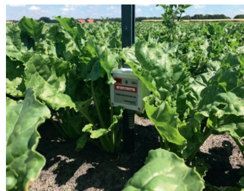
Figuur 24 Een sensor die de omstandigheden in het bietengewas meet en doorstuurt naar de server. Op basis van de meetwaarden worden voor dit perceel specifieke infectiekansen berekend.
