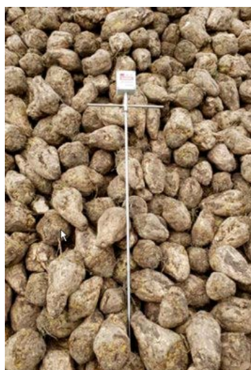
Afbeelding 6. Gebruikte sensor voor temperatuurmonitoring
